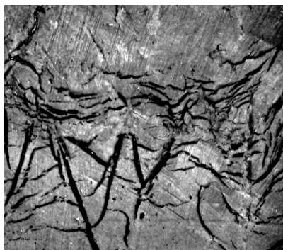
Рис. 3.36. Верхняя часть образца. Вертикальный срез. Слой слоисто-сетчатых криотекстур (слой 4) и перекрывающий его слой массивной криотекстуры (слой 5). Фото П.А. Соболева
