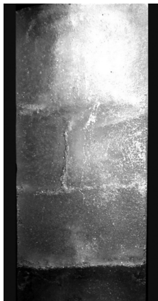
Рис. 3.19. Образец льда, приготовленного послойным наливом. Фото П.А. Соболева
