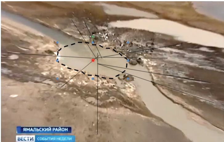
Рис. 4.19. Определение места взрыва: прямые линии проведены по направлениям вытянутых выемок; пунктир — граница выброса крупнообломочного материала (внешняя граница кратера). Скриншот видео [http://www.yamalpro.ru/2017/07/03/iz-novoy-yamalskoy-voronki-prodolzhaet-sochitsya-metan/]
