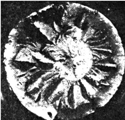
Рис. 5.9. Поверхность излома образцов стали после испытания на растяжение [Свидинович и др., 2011]
