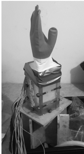
Рис. 3.14. Установка для исследования фильтрации газа в мёрзлых грунтах. Фото П.А. Соболева
