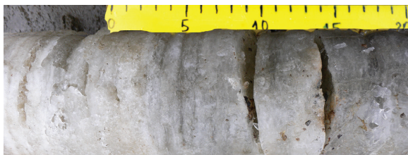
Рис. 1.4. Газонасыщенный (молочный) лёд вблизи воронки газового выброса, глубина 5,8–6,3 м (Ямальский кратер). Фото В. Хилимонюк [Buldovich et al., 2018]
