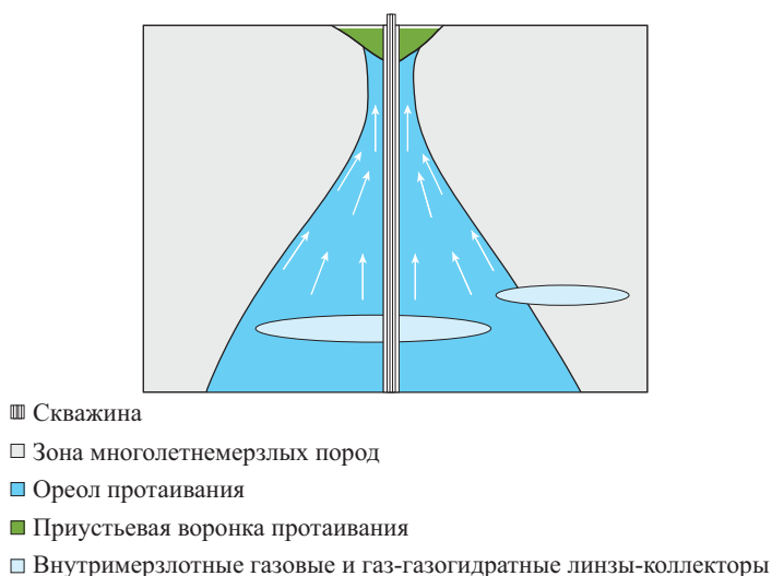
Рис. 5.17. Схема формирования потока внутримёрзлотного газа при оттаивании ММТ вокруг работающей скважины [Аветов и др., 2018]
