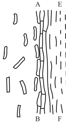
Рис. 5.24. Рассредоточенное разрушение на фронте выброса [Петухов, Линьков, 1983]
