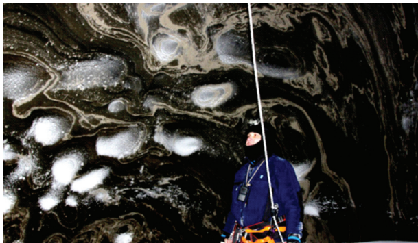
Рис. 6.3. Струйная дегазация из зоны каверн с повышенным давлением газа (ноябрь 2014 г.). Фото В.А. Пушкарёва
