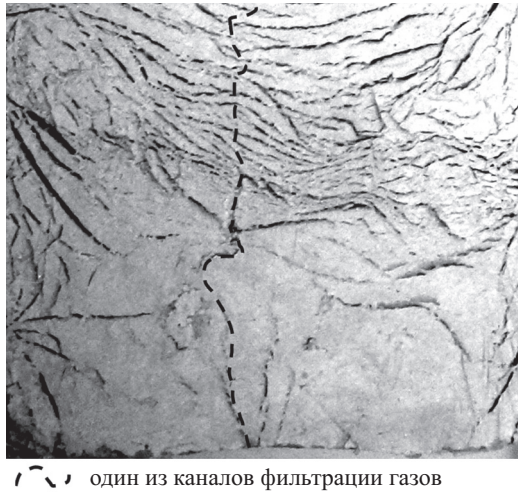
Рис. 3.33. Криогенное строение нижней части образца каолина. Фото П.А. Соболева
