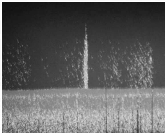
Рис. 2.7. Метановый факел, зарегистрированный с помощью эхолота в центральной части моря Лаптевых в сентябре 2007 г. [Шахова и др., 2009]
