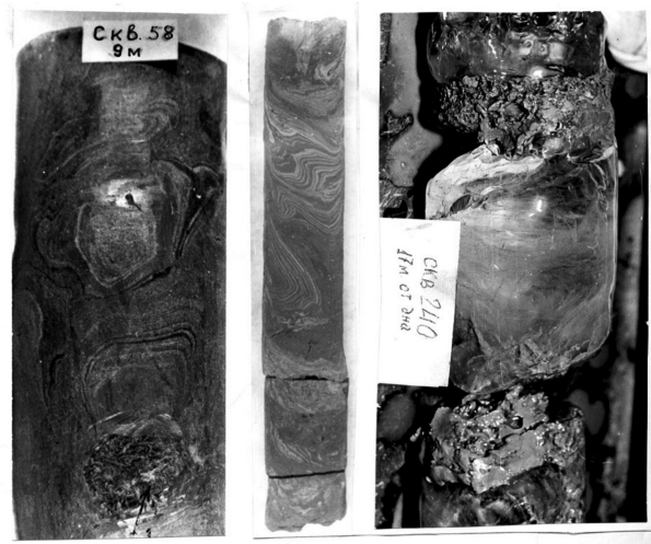
Рис. 2.12. Подземный лёд в дислоцированных донных отложениях Баренцево-Карского шельфа по скважинам [Бондарев и др., 2001]
