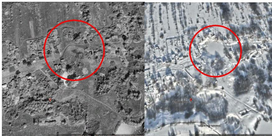
Рисунок 5.6. Район пос. Белозерье. Развитие карстового провала, произошедшего в августе 2012 г. Слева - понижение, справа – провал с водой.
