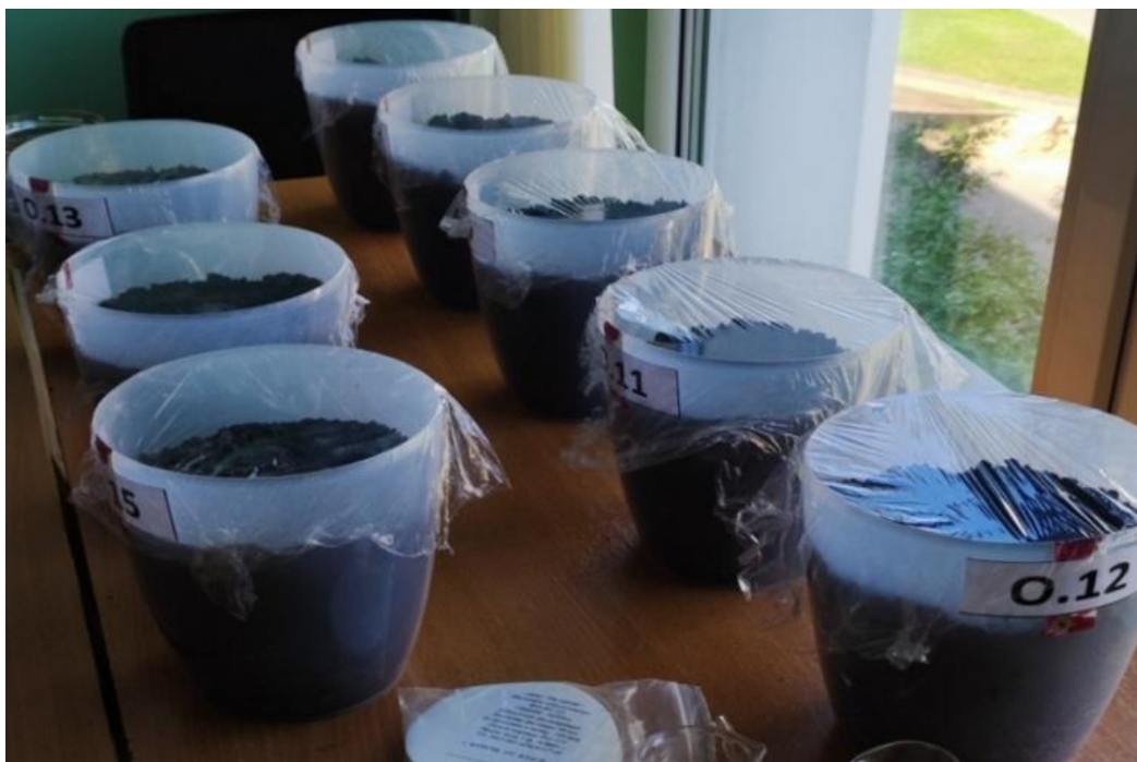
Рис. 21. Инкубация образцов, содержащих фиторемедианты.
