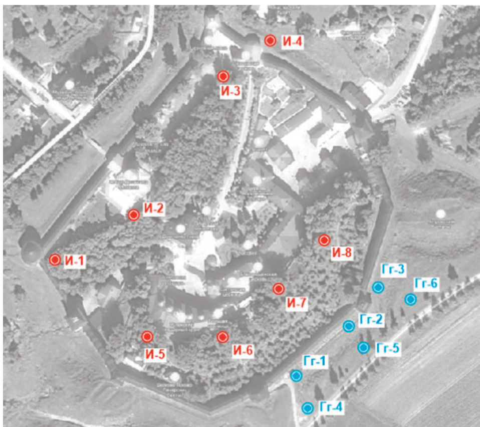
Рис. 4. План расположения гидрогеологических и инклинометрических скважин
