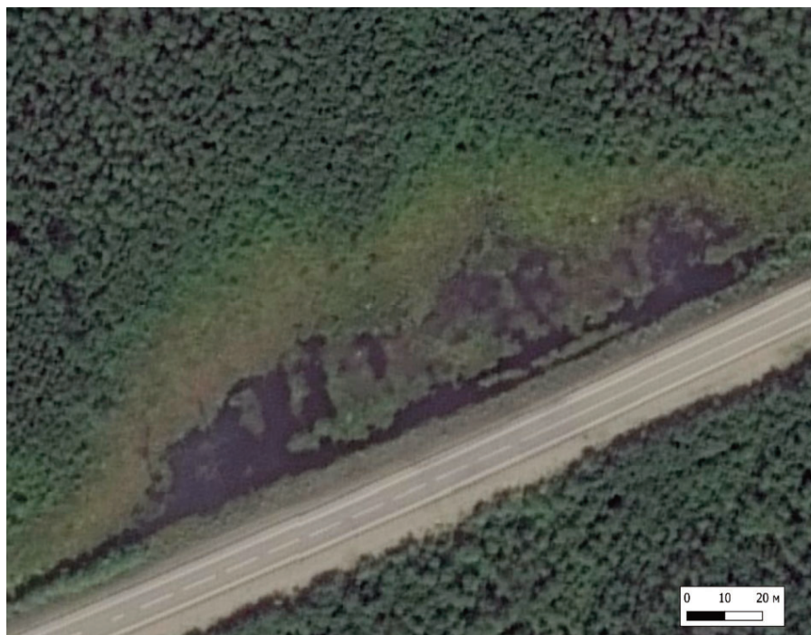
Рис. 1. Пример отражения на космическом снимке подтопления автодороги и термокарста по полигонально-жильным структурам (разрешение снимка 0,5-1 м)
