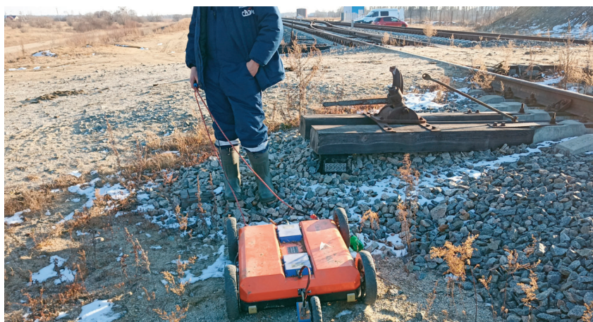
Рис. 1 - Проведение георадарных исследований
