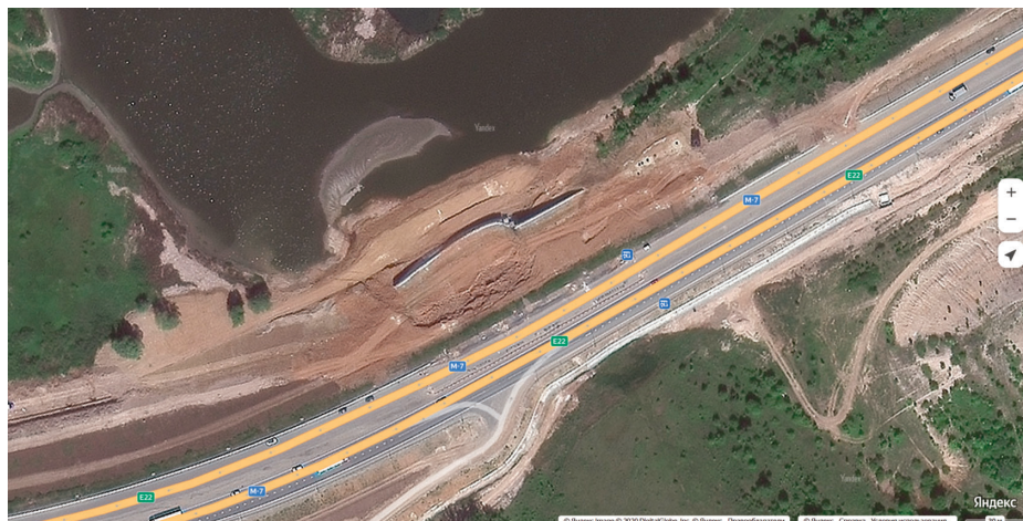
Рис. 3. Космоснимок участка активизации деформаций откоса автомобильной дороги [3]
