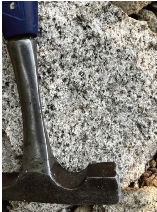
Рис. 1. Граниты биотитовые, светло-серые, среднекристаллические
