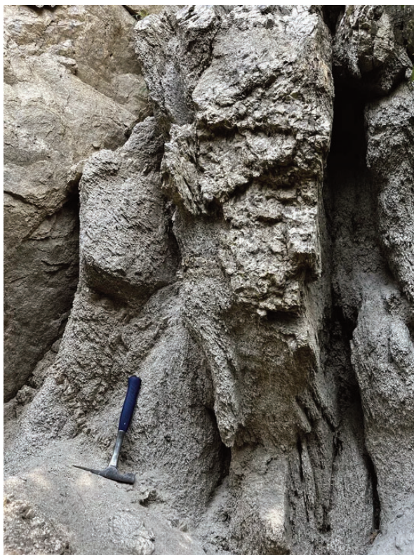
Рис. 4. Зона дробления, заполненная дезинтегрированными до дресвы гранитами
