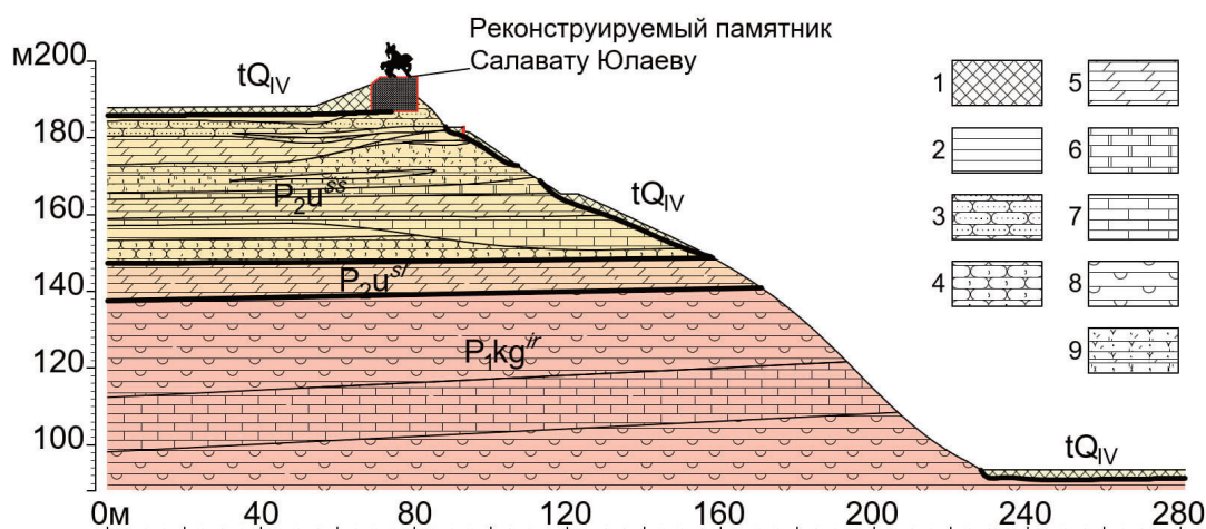
Рис. 2. Геолого-литологический разрез: P_1kg^{ir} – пермская система нижний отдел кунгурский ярус иренский горизонт, P_2u^{sl} , P_2u^{ss} – пермская система нижний отдел уфимский ярус соликамский и шемшинский горизонт соответственно, 1 – насыпные отложения, 2 – глины, 3 – песчаники, 4 – алевролиты, 5 – мергели, 6 – доломиты, 7 – известняки, 8 – гипсы, 9 – переслаивающиеся терригенные, карбонатные и сульфатные породы нерасчлененные
