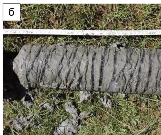
Рис. 3. Фрагменты кернов скважин: а – повторно-жильный лед в керне Сква. А1-3; б – текстурообразующий лед в керне Сква. А2-1
